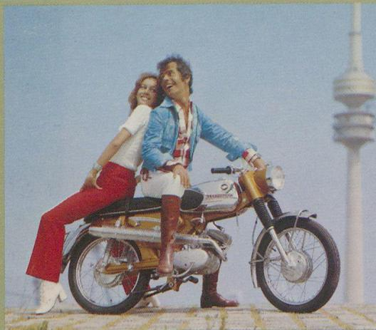
**KS 125 Sport:** Top-Star von ZÜNDAPP. 15 PS, 125-ccm-Motor. Schrägverrippter Breitwand-Zylinder, sportlich erprobter Doppelschleifenrahmen, 5-Gang-Getriebe. (Ausführliche Beschreibung – Motorrad-Prospekt.) Führerschein Klasse 1, ab 18 Jahren.
